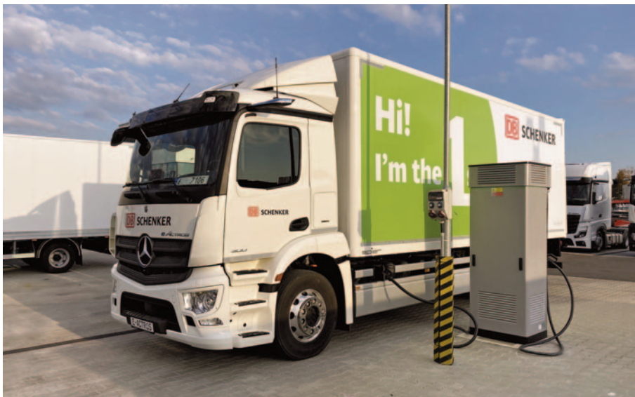
Nabíjení z 20 na 80 procent z rychlonabíjecího stojanu (MB Praha Stodůlky) proudem 400 A trvá nepatrně déle než hodinu.
