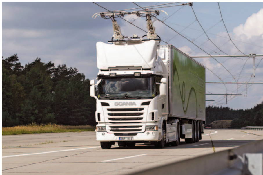
Vozidla pro trolejový systém, který se testuje ve Skandinávii i v Německu, pocházejí od značky Scania.
