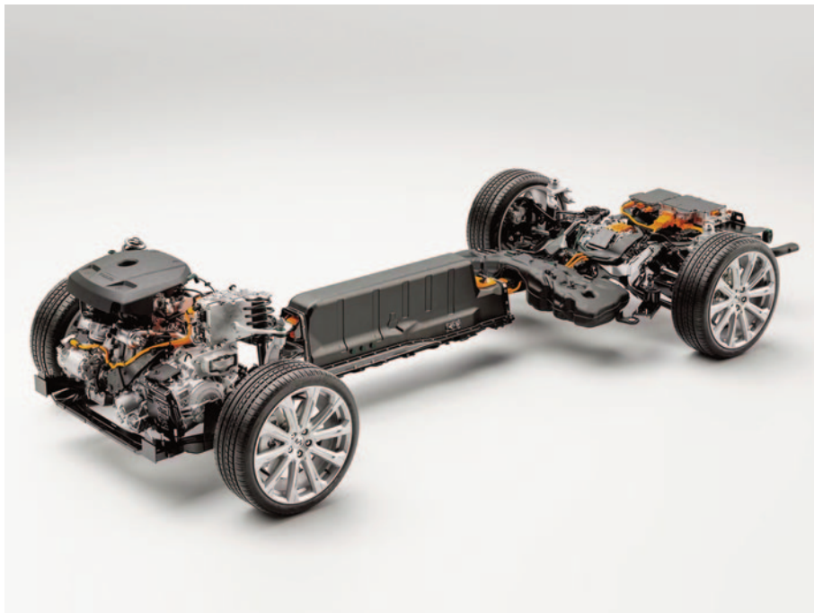
Pohled pod „pokličku“ Volvo XC60 Recharge, tedy vozu PHEV.
